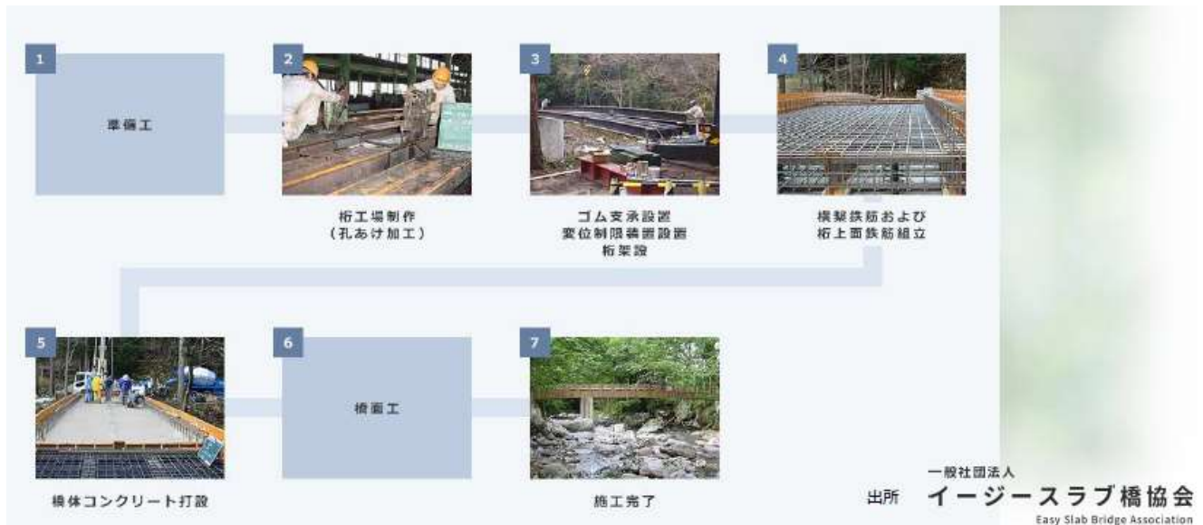
図9 イージースラブ 施工フロー
